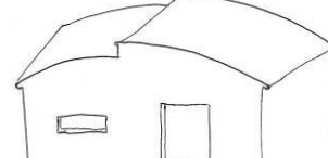
Toit bombé dit en berceau
