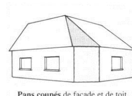
Pans coupés de façade et de toit
